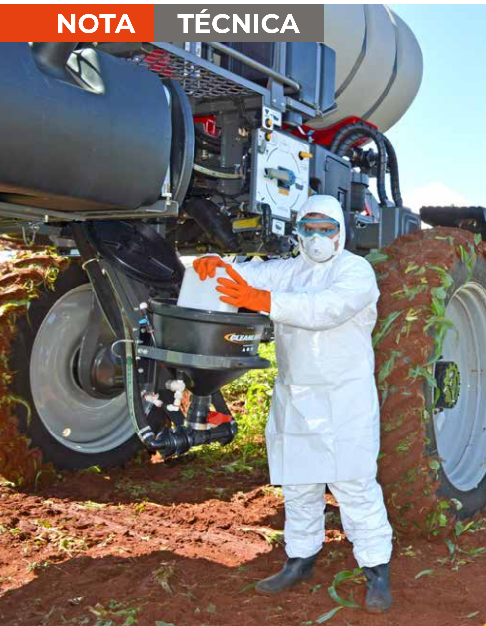
Los equipos de protección individual deben usarse al momento de la carga de la máquina aplicadora.
