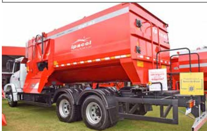
**I**pacol entre su amplia y variada gama destacó como lanzamiento en Agrishow el vagón distribuidor de abono orgánico, modelo VDE construido en acero inoxidable. Es
